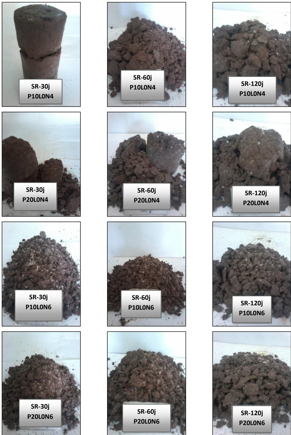
Fig. 5.17 — Epreuves du SR complètement altérées après traitement avec l'addition de la pouzzolane naturelle en présence de 4 et 6% du \text{Na}_2\text{SO}_4 pendant 30, 60 et 120 jours de cure.
